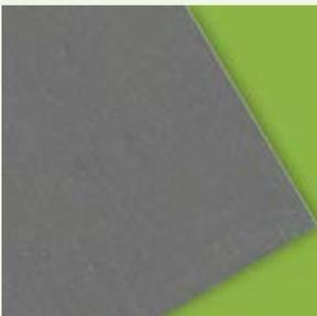
Gepresste Dichtungsringe bestehend aus 98%-reinem Graphitexpandat ohne Bindemittel. Gute chemische Inertanz, hohe Wärmeleitfähigkeit, von Natur her schmierend.
