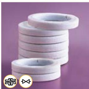
Packung bestehend aus einer geflochtenen Seele aus PTFE-impregnierten Kohlenstoffgarnen, die von einer Hülle aus geflochtenen und geschmierten PTFE-Garnen ummantelt ist. Durch ihre elastische Struktur wird auch bei niedrigem Anpressdruck eine gute Dichtheit gewährleistet. Sehr geringe Reibung.
