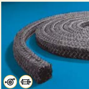
Packung bestehend aus einem exklusiv für LATTY® hergestellten Garn aus Kohlenstoff- und Aramidfasern die einzeln nach unserem exklusiven «Filcoat-Verfahren» mit PTFE imprägniert werden. Beim Flechtvorgang werden sie zusätzlich mit einer PTFE-Mischung und einem neutralen, lebensmittelechten Schmiermittel imprägniert.
