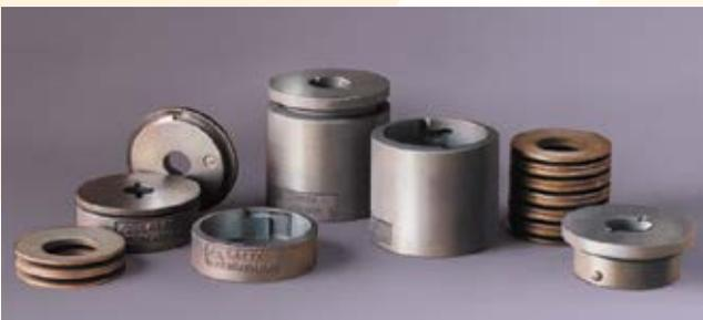
Das **LATTY® Live Loading System** ist ein vorgespanntes, kalibriertes, dynamisch ausgleichendes Anpresssystem, dessen Rolle darin besteht, einen gegebenen Anpressdruck über die Stopfbuchsbrille auf einen Packungssatz zu übertragen.
