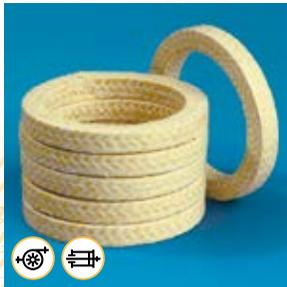
Packung bestehend aus 100% Aramid-Endlosfasern, die einzeln nach unserem exklusiven «Filcoat-Verfahren» mit PTFE imprägniert, und dann beim Flechtvorgang mit einer Mischung von PTFE und einem neutralen, lebensmittelechten Schmiermittel nochmals imprägniert werden.
