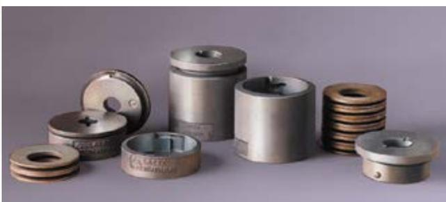
**LATTY® Live Loading System** ist ein vorgespanntes, kalibriertes, unveränderbares, dynamisch ausgleichendes Anpresssystem, dessen Rolle darin besteht, einen gegebenen Anpressdruck über die Stopfbuchsbrille auf einen Packungssatz zu übertragen.
