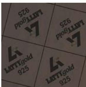
Kalandriertes Dichtungsmaterial aus ausgewählten Kunststoff- und Mineralfasern, die mit einer auf Acrylnitrilkautschuk basierenden Mischung zusammengebunden werden. Dieses Dichtungsmaterial wird mit einer Drahtgeflechteinlage verstärkt.
