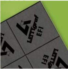
Dichtung bestehend aus 98%-reinem gewalzten Graphitexpandat, die auf einer 50µ-dicken nichtrostenden Stahlfolie ISO 1.4401 geklebt werden.
