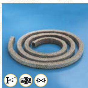
Geflochtene Packung aus hochtemperaturfesten Glasfaser-garnen, die mit Nickel-Chrom-Draht verstärkt und mit einer Glimmer-Mischung imprägniert ist.
