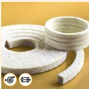
ackung bestehend aus technischen Polyacrylgarnen. Die Garne werden nach unserem exklusiven «Filcoat-Verfahren» mit PTFE imprägniert und beim Flechtvorgang mit einer Mischung aus PTFE und einem neutralen, lebensmitteltechnischen Silikonschmiermittel zusätzlich imprägniert.
