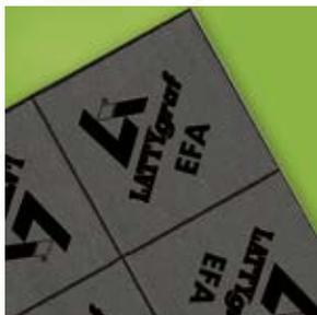
Dichtung bestehend aus 98%-reinegewalzten Graphitexpandat tafeln, die auf einem Spiessblech aus nichtrostendem Stahl ISO 1.4404 geklammert werden. Diese Struktur hängt wegen der Kohäsionskräfte und ohne Bindemittel zusammen.
