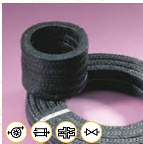
Packung bestehend aus 100% reinen PTFE-Seidengarnen, die durch und durch mit Graphit impregniert und mit einem Silikonöl geschmiert sind.
