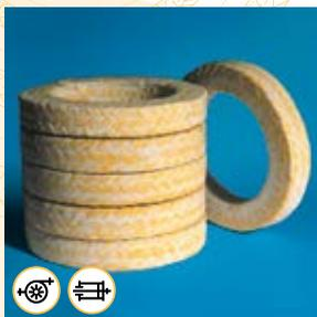
Packung bestehend aus Aramid- und Viskosegarnen. Die Garne werden einzeln nach unserem exklusiven «Filcoat-Verfahren» mit PTFE imprägniert. Beim Flechtvorgang werden sie zusätzlich mit einer PTFE-Mischung und einem neutralen, lebensmittelechten Schmiermittel imprägniert.
