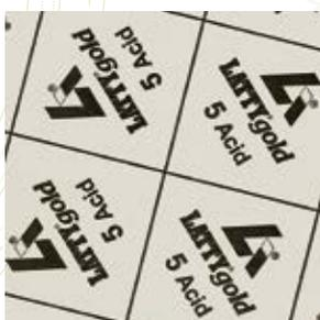
Kalandriertes Dichtungsmaterial aus ausgewählten Kunststofffasern, die mit einer Mischung von Harzen und Elastomeren, die sehr beständig gegen die Wirkung von sehr angreifenden Produkten sind, zusammengebunden und als Tafeln komprimiert werden.
