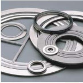
Patent-Verbunddichtung bestehend aus einem massiven Graphitexpandatdichtungsring **LATTY®graf E**, der zwischen zwei nichtrostenden Stahlringen gepresst wird. Diese Stahlringe dienen als Druckbegrenzer.
