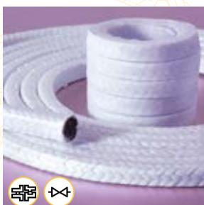
Packung bestehend aus einer geflochtenen Seele aus PTFE-impregnierten Kohlegarnen und einer Ummantelung aus kreuzgeflochtenen, impregnierten und geschmierten PTFE-Garnen.
