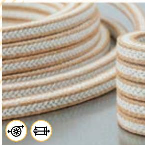
Packung mit Kern aus Graphit, auf den Kanten, aus Phenolverbundgarnen, die einzeln nach unserem exklusiven «Filcoat-Verfahren» mit PTFE imprägniert werden und Gleitflächen aus Polyacrylgarnen. Geschmeidige und robuste Packung mit sehr hoher Festigkeit gegen sehr unreine Medien.
