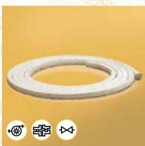
Packung bestehend aus technischen Polyacrylgarnen. Die Garne werden nach unserem exklusiven «Filcoat-Verfahren» mit PTFE imprägniert und beim Flechtvorgang mit einer PTFE-Mischung zusätzlich imprägniert.
